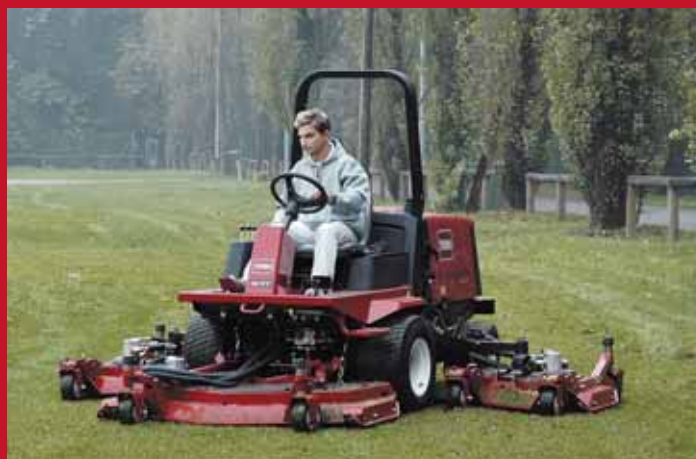
A sinistra, trattore compatto Iseki TM 3240, con apparato di taglio da 122 cm e raccolta idraulica. Sopra, tosaerba Toro Groundmaster 400 all'opera; la larghezza di taglio totale è pari a 335 cm.
