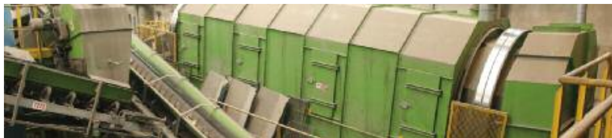
Un gruppo di raffinazione dimensionale e densimetrica per la qualificazione d'uso del biostabilizzato.
