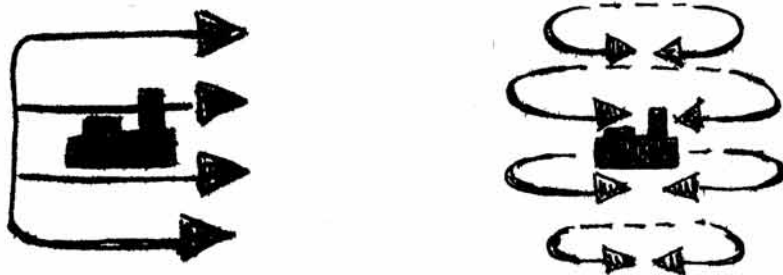
Figura 1.2: Ecosistema “aperto” ed ecosistema “chiuso”: nel primo caso (sistema aperto) si ha uno scambio continuo di materia ed energia con l’esterno (ad esempio, una città ottiene acqua, energia, alimenti ecc. dall’esterno ed i prodotti di rifiuto vengono trasportati al di fuori), nel secondo (sistema chiuso) lo scambio con il mondo esterno avviene soltanto a livello di energia (i materiali di scarto vengono riciclati, tornando a costituire una risorsa).
