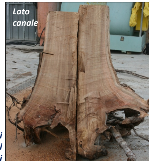
Radici con poca penetrazione nel sottofondo e danni meccanici
