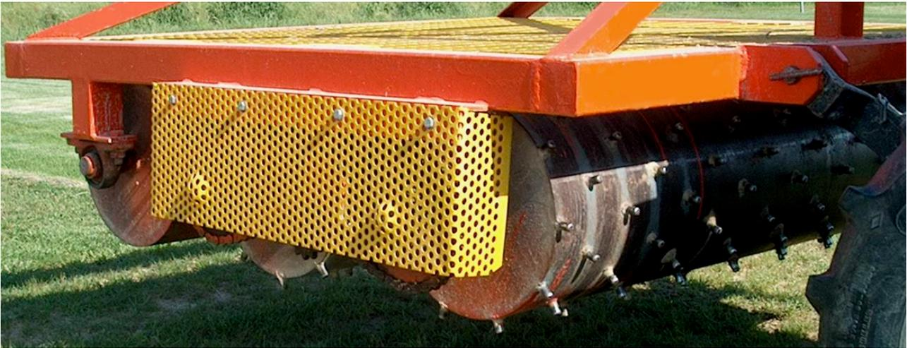
Fig. 3. Dettaglio del simulatore di calpestamento.
