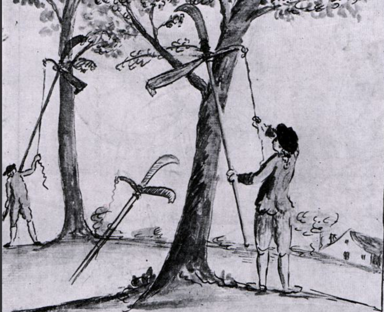
Forbici per tagliar de rami di un albero di qualunque altezza senza avere bisogno di scala. (Senza disposizione) in Francia
