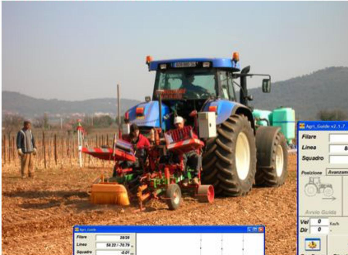
**SMARTWINE** Controlla automaticamente lo spostamento idraulico della trapiantatrice in base alle informazioni progettuali
