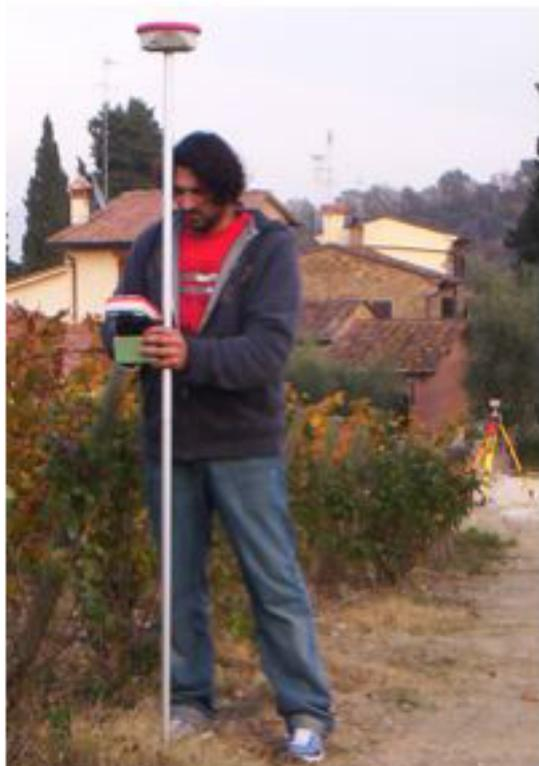
FASE DI RILIEVO E' la procedura di acquisizione delle coordinate del perimetro dell'area di impianto, nel sistema di riferimento stabilito dall'operatore. (Locale o topografico) . Dopo aver memorizzato i punti esterni dell'area del contorno dell'appezzamento del terreno , l'operatore creerà in base alla propria esperienza, un progetto d'impianto, stabilendo i seguenti elementi:
