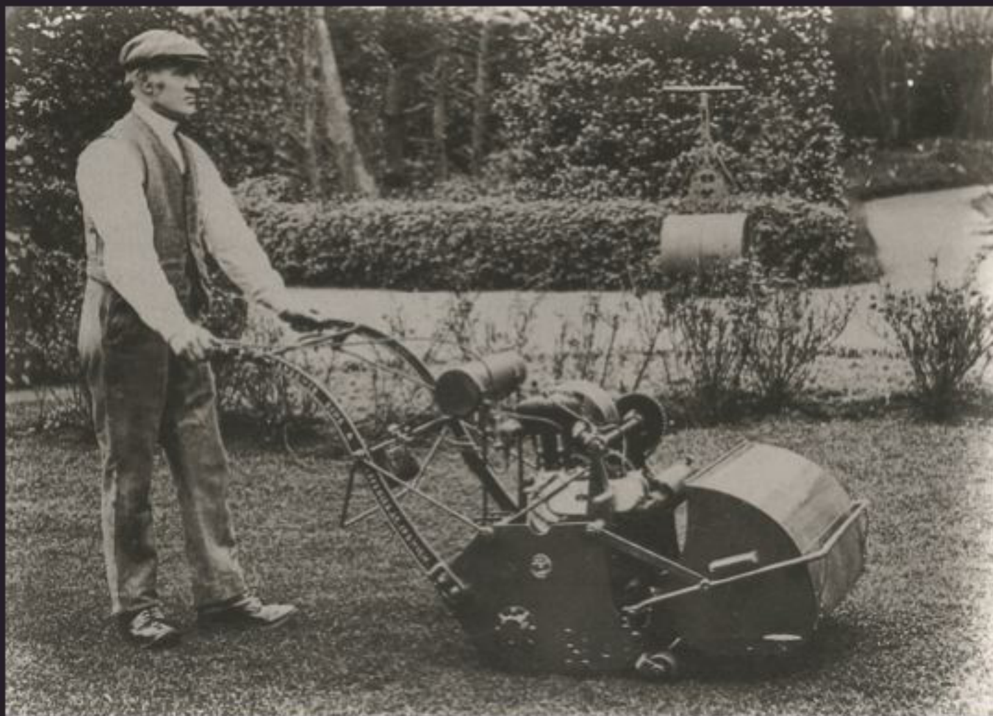
Giardiniere al lavoro alla guida di uno dei primi modelli di falciatrice meccanica con motore a vapore.
